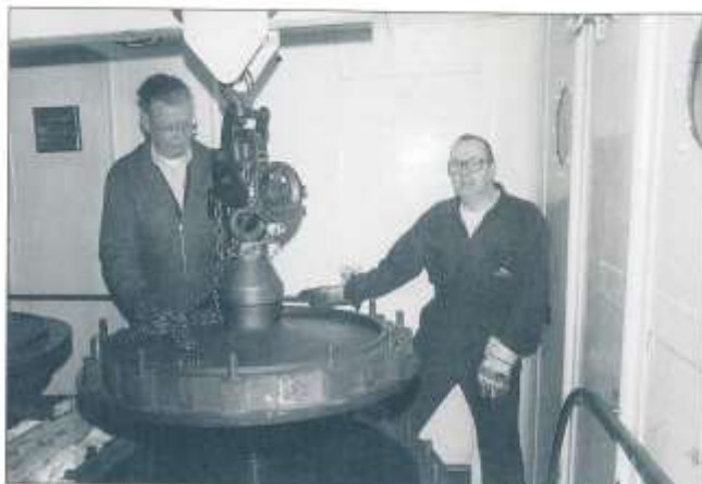
Lågtrycksholven lyft för renovering av kolvringar våren 2000. Från vänster Steinar Læ og Gunnar Björnbåge. Foto Walter Fogelström.
